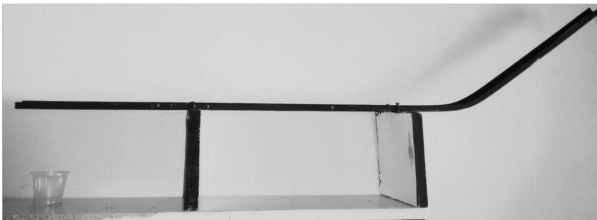
Em seguida foi colocada a fita crepe enumerada dentro da canaleta. As numerações foram em ordem crescente do início da curvatura superior até o final da curvatura em baixo.
